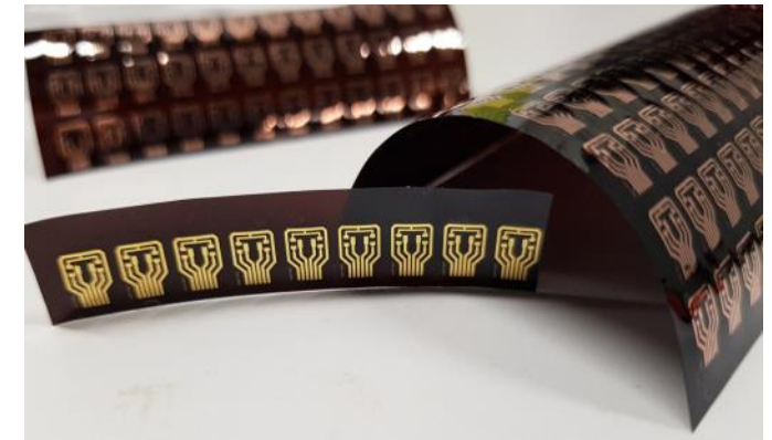
Oben: Sensorsystem auf Kunststoffolie, flexibel und dünn
