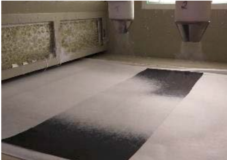
Vliesherstellung aus PEEK durch Meltblow
