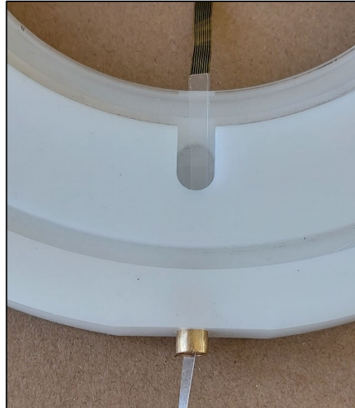
Durchführung Schaltungsträger durch Zellrahmen (100 cm 2 )
