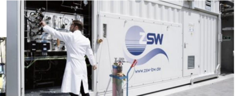
CE-zertifizierter Prototyp des ZSW 1 MW el Alkalische Druckelektrolyse
